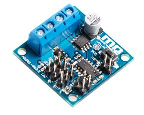
La *Easy Motor Controller* permette di controllare la velocità e la direzione di rotazione di un motore DC attraverso tre possibili input differenti: analogico (potenziometro), radiocomando RC, comunicazione digitale I2C.
